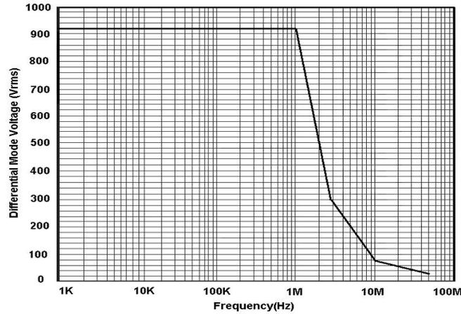
图 1: 最大差模电压 VS 频率曲线
