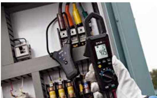
连接TA74柔性电流钳优化测量操作
