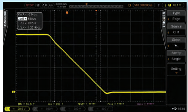
直流电压跌落 @ 100Vdc/ms
